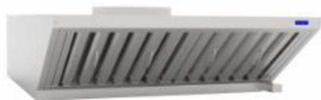
Зонт вытяжной встраиваемый ЗВВ-6-6/4М для конвекционной печи КЭП-6П-01 используется для очистки воздуха от аэрозолей жира, масла и водяного пара. Зонт устанавливается в системе вытяжной вентиляции (диаметр отводящей трубы и дымохода должен быть не менее 270 мм) на объектах общественного питания.
